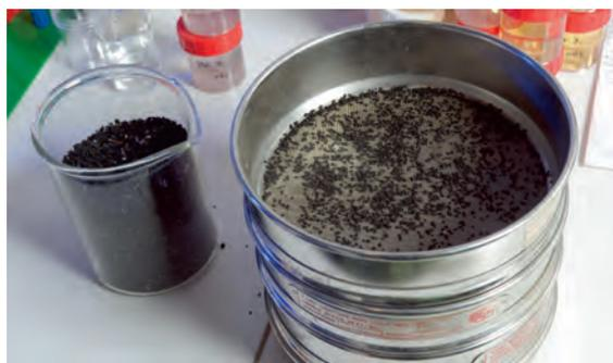
Un échantillon de 500 grammes de granulats passe à travers six tamis successifs. On retire ensuite manuellement les fibres textiles, libres ou liées à des granulats, qui ont été retenues dans chaque tamis. Ces résidus sont ensuite pesés.
