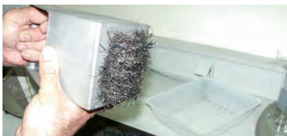
Après avoir étalé une couche de 1 à 1,5 cm de granulats sur un plateau, on passe un aimant à environ 1 cm de sa surface. Les fils métalliques adhérant à l'aimant sont ensuite récupérés dans un bac. Après avoir mélangé les granulats, on répète l'opération jusqu'à ce que l'aimant reste vierge de tout résidu métallique. Enfin, on pèse les fils récupérés.
